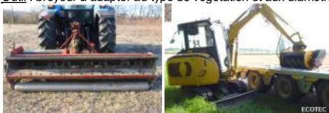
Figure 5 : Exemples de broyeurs ; à gauche broyeur tracté pour des faibles diamètres de ligneux; à droite : broyeur pour des diamètres de ligneux plus conséquents
