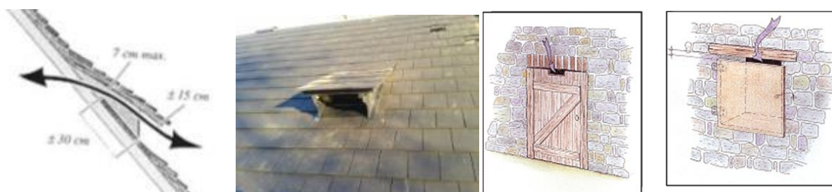
Figure 33 : à gauche, schéma d'une chiroptière, au centre : photo d'une chiroptière, source Picardie Nature, à droite : ouverture simple, source Groupe chiroptère de Provence
