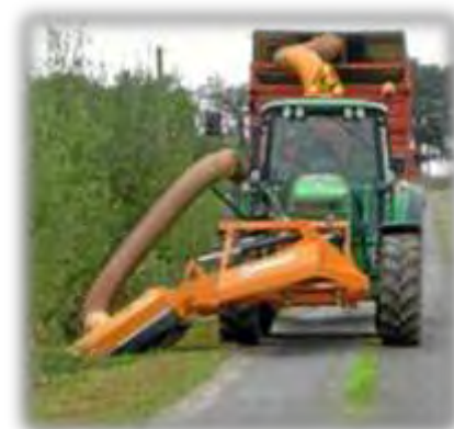
Figure 26 : le long bras greffé à la machine permet d'aspirer instantanément toute la végétation fauchée en bord de route (Source : Couesnon-Marches de Bretagne)
