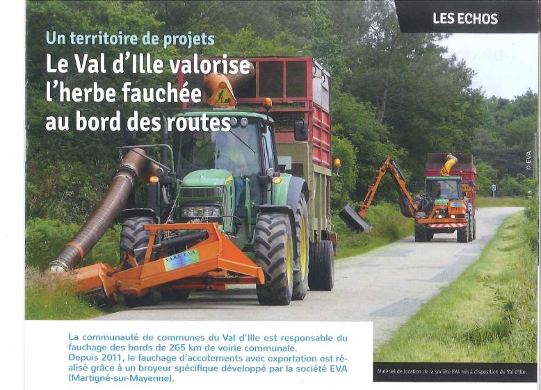
e broyeur d'accotements est loué par le Val d'Ille dix semaines par an. L'herbe fauchée n'est pas laissée sur place, mais récupérée grâce à un système d'aspiration, pour ensuite être valorisée sous forme d'énergie ou de compost.
